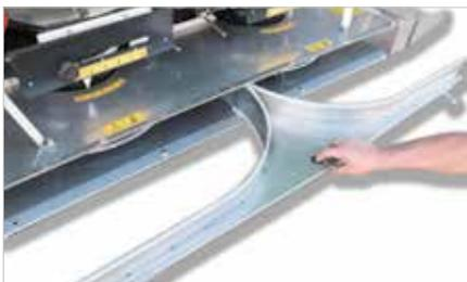
Schnelle Änderung der Verteilung von REIHEN- ZU VOLLFELDSTREUEN: durch Abschrauben von zwei Sternschrauben wird das Innengehäuse entfernt und die seittl. Auswurfverlängerungen werden aufgeklappt - der DELTA fruit ist für die Verteilung im freien Feld vorbereitet..
