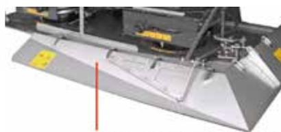
**Randstreifen:** Mit dieser hydraulischen Vorrichtung für die Düngung der Vorgewende von Parzellen, deren Durchgänge nur 2 m vom Rand entfernt sind, ist gewährleistet, dass der Dünger nicht über die zu behandelnde Parzelle hinausgeht.
