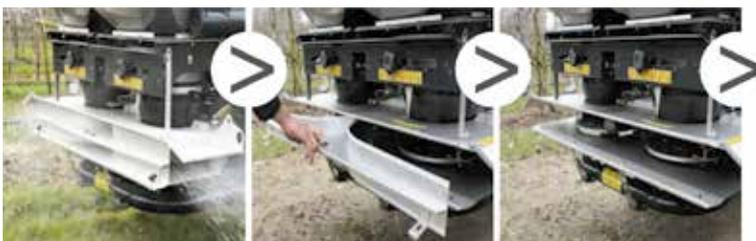
Schnelle Änderung der Verteilung von REIHEN- ZU VOLLFELDSTREUEN: nach Abschrauben von zwei Sternschrauben wird das Innengehäuse entfernt und DAVID fruit ist für die Verteilung im Vollfeld umgerüstet.
