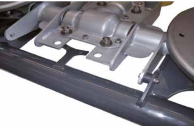
Das **TANSMISSION PROTECTION SYSTEM** verhindert Beschädigung von Getriebekomponenten bei Verwendung einer zu langen Gelenkwelle. Der zentrale Getriebekasten wird mit **sechs Silentblöcken** mit dem Rahmen verbunden, somit werden abnormale Biegespannungen durch eine nicht optimale Kopplung mit der Zugmaschine absorbiert.
