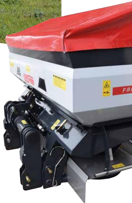
DIGIDevice Dosierelektronik, 10 Hz-Wiegetechnik mit 2 Wiegezellen zu je 5.000 kg, ein kompakter Wiegerahmen mit geringem Schwerpunktversatz nach hinten, zwei 12-V-Verstellmotoren und zwei Magnetsensoren sorgen für eine exakte Dosierung und Kontrolle
